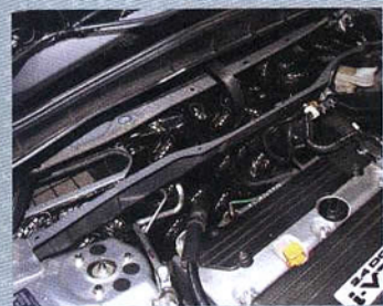
1. 发动机挡火墙粘贴止振垫，可有效阻止发动机振动及噪音传入车内。
