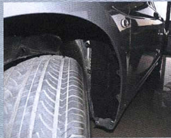
5. 轮拱内粘贴止振垫及吸音绵，抑制前翼子板共振噪音，阻挡轮胎噪音传入车内。
