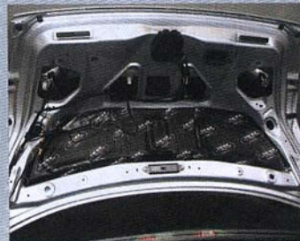
6. 行李厢盖内加贴止振垫及吸音绵，减少行李厢盖钢板共振，阻挡车尾噪音传入。
