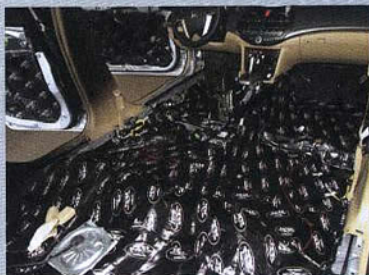
2. 底盘全部粘贴止振垫及吸音绵，抑制行驶中底板产生的共振噪音，阻挡路面反射的其它噪音传入。
