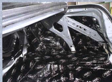
3. 后备厢及后翼子板粘贴止振垫及吸音绵，可以有效降低车后部大面积钢板产生的共振噪音。
